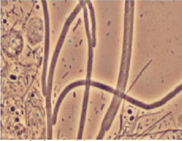
Sphaerotilus natans ينمو في الحمأة بأحواض التهوية نتيجة انخفاض تركيز الأكسجين الذائب.
