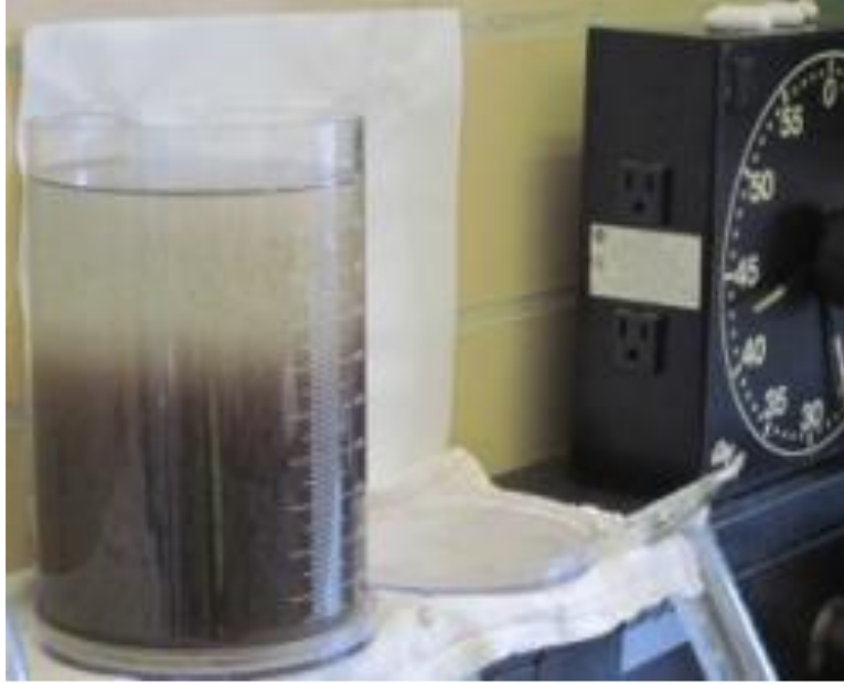
شكل رقم (5 - 13) يوضح بطئ ترسيب الحمأة
